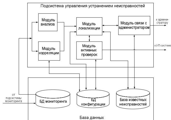
**Рис. 12. Структура подсистемы управления устранением неисправностей**
