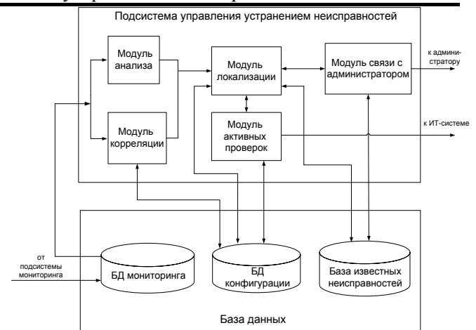
Рис. 12. Структура подсистемы управления устранением неисправностей
