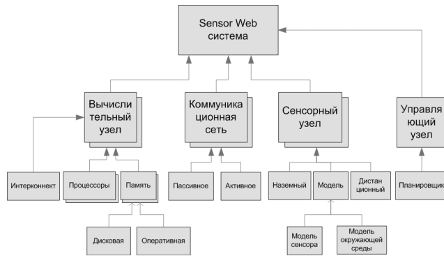
Рис. 2. Структурная модель системы Sensor Web
