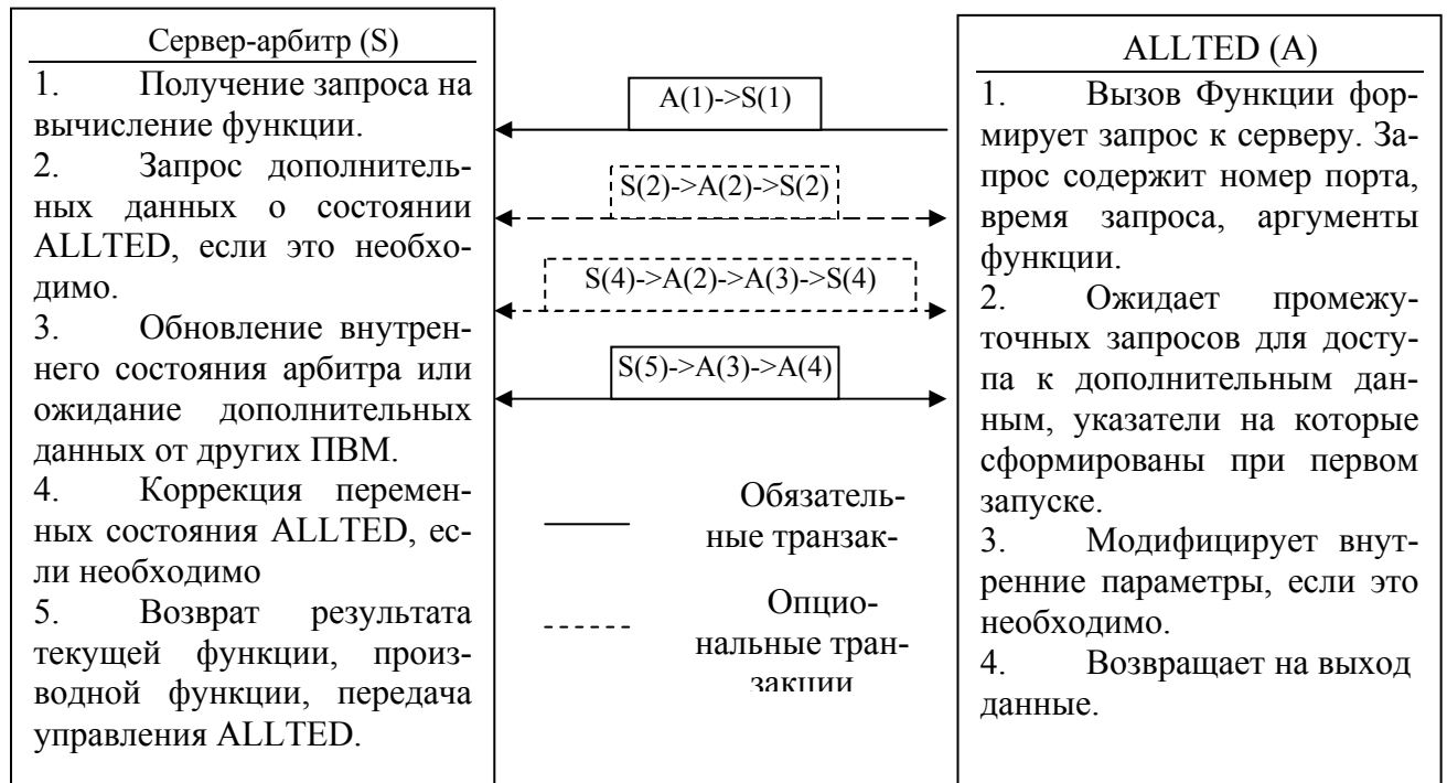
Рис. 4. Обобщенный протокол обмена данными ALLTED-арбитр
