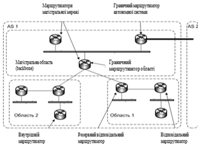
Рис. 1. Автономна система, що розділена на області маршрутизації
